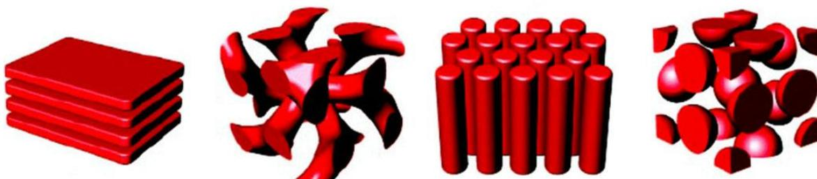
**Рисунок I.2.** Типы морфологий расплава диблок-сополимера: ламеллярная ( $L$ ), гироидная ( $G$ ), цилиндрическая ( $C$ ), сферическая ( $S$ ). Изображены блоки только одного сорта.
